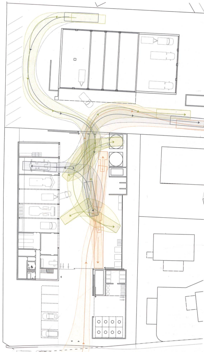
Werkhof Matzingen: EG mit eingezeichnetem Schleppkurvenkonzept. Mst. 1:600.
