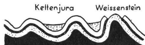
Abb. 1. Querschnitt durch den Faltenjura bei Solothurn. Weisse Schicht = Malm, gekörnte = Dogger
