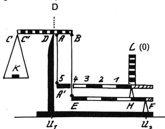
Ferner stellen wir fest, dass die Ladebrücke sich stets parallel zu sich selbst verschiebt. Legt man die Last bei Punkt 0 (Grenzfall) auf und es senkt sich 0 (L) (und auch H) um z. B. 1 cm, so senkt sich E (B) um 5 cm; denn HF ist in EF 5mal enthalten. Da aber AD nur  $\frac{1}{5}$  von BD ist, senkt sich A' um 1 cm, also wie 0. Senken wir Punkt 5 um 1 cm, so senkt sich A um 1 cm, B (E) jedoch um 5 cm, und H (0) folgt entsprechend mit nur 1 cm, da  $FH = \frac{1}{5}$  von EF ist.
