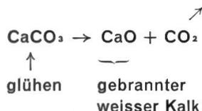
Ein Kalkofen wird wechsellagernd mit Koks und Kalkstein gefüllt und der Koks entzündet. In der grossen Hitze entweicht das Kohlendioxyd aus dem Kalkstein. Von Zeit zu Zeit kann der gebrannte Kalk unten aus dem Ofen herausgenommen werden.
