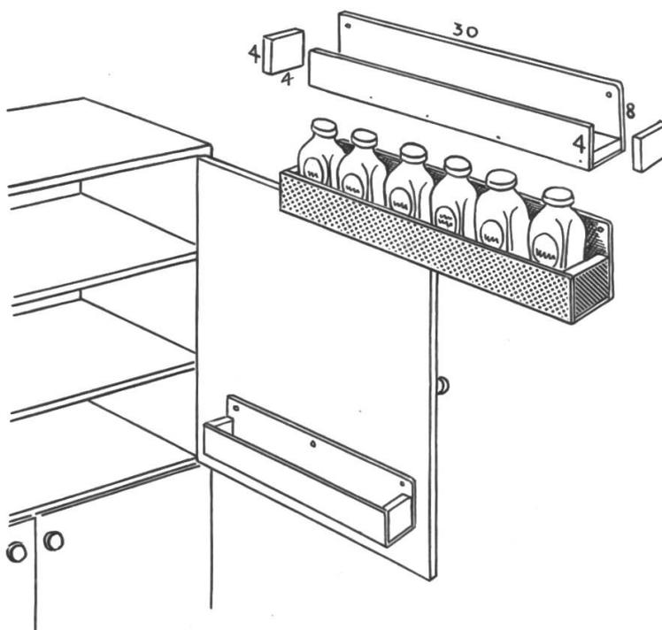
sind aus Pavatex, dessen rauhe Seite wir den Gläschen zukehren, so dass diese ein bisschen eingeklemmt werden. Sie sollen nicht rutschen und nicht klappern, wenn man die Türe öffnet oder schliesst.
