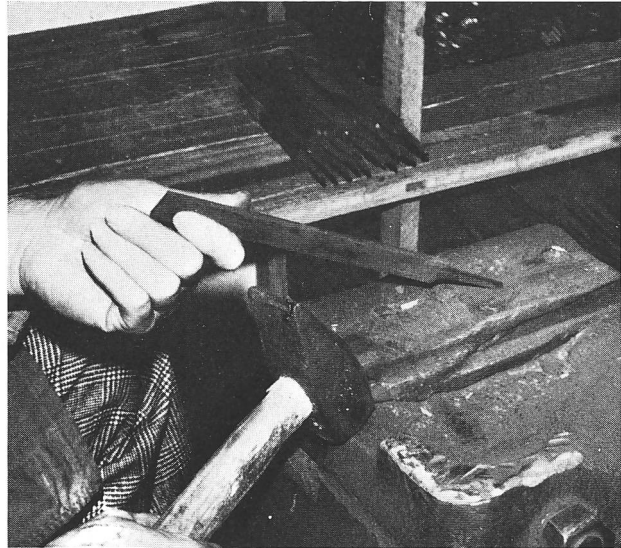
4 mit dem Eisenhammer und -amboss richten
