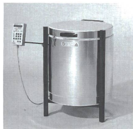
Brennofen KITTEC 95 Liter Die TOP-Lader
