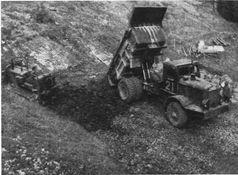
Bild eines Euclids mit gekippter Ladung von 12 m 3 .
