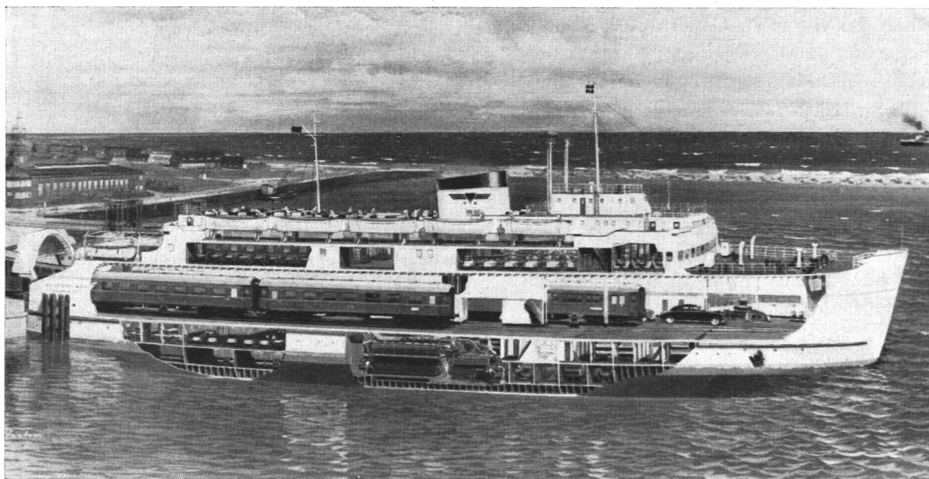
Das Innere des Fährschiffes ‚Deutschland‘, das zwischen Großenbrode und Gjedser (auf der dänischen Insel Falster) verkehrt. Zuunterst sehen wir die Maschinenanlage, darüber den Raum für Eisenbahnwagen und Autos und oben die Aufenthaltsräume für die Reisenden während der Überfahrt, ganz oben Kommando- und Steuerraum. – Eine der 6 Illustrationen (wovon eine mehrfarbig) zum Artikel ‚Im Eisenbahnzug über das Meer‘.
