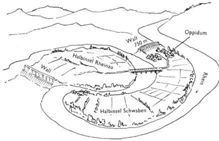
8. Die keltische Stadt war mit der sogenannten Keltenmauer gegen außen geschützt. Balken wurden quer übereinander aufgeschichtet, die Steine nur lose hineingelegt. Mörtel kannte der Kelte nicht. (Der Römer versuchte bei Belagerungen, mit Sichel, die an lange
