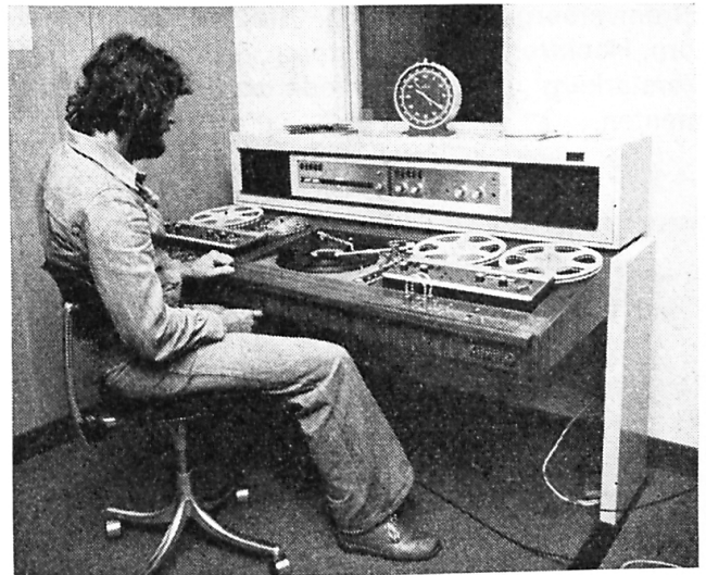
Tonträgertisch vor der Sprechkabine Er enthält alle für die Tonaufnahme und -wiedergabe notwendigen Geräte. (Photo: Autophon)
