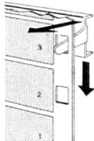
Der Filmgreifer wird präzise in die Perforation eingeführt. Da er sich in dieser Phase vertikal kaum bewegt, trifft er weich auf den Perforationsrand. (Hier wird bereits die erste Geräuschquelle ausgeschaltet.)
