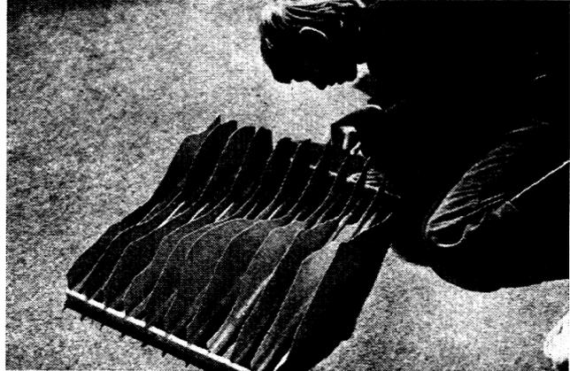
Die Längsschnitte, auf Karton gezeichnet und ausgeschnitten, werden in kartenproportionalen Abständen auf eine Platte gestellt. Damit die Karton-Längsschnitte stehen, sind sie an eine Holzleiste angenagelt.
