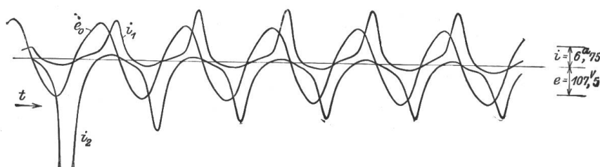
Abb. 7. Beide Transformatoren unbelastet. e_0 = Spannung. i = Strom in der gemeinsamen Zuleitung. i_2 = Einschaltstrom des zweiten Transformators. R = 0,04 Ohm.
