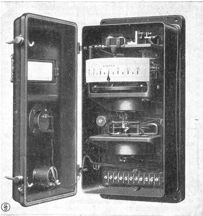
Fig. 1. Geber-Instrument, Gehäuse geöffnet.
