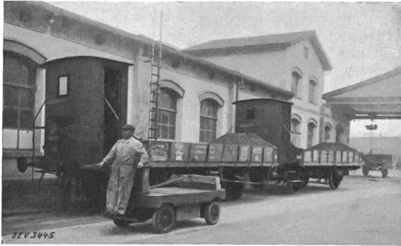
Fig. 6. Elektrokarren beim Ziehen von Eisenbahnwagen.
