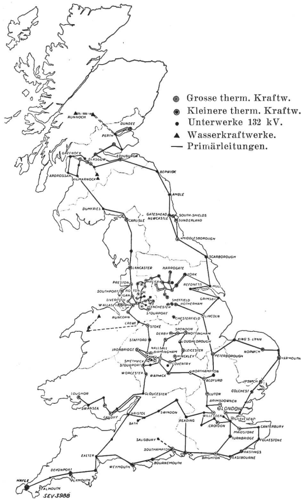
Fig. 1. 132-kV-«Primärleitungen» des Central Electricity Board.
