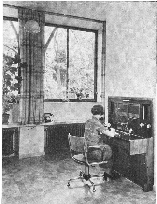
Vermittlerschrank für 40 Amtsleitungen
