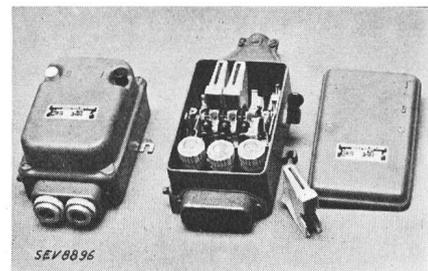
**Beschreibung:** Dreipolige Motorschutzschalter gemäss Abbildung, in Gussgehäuse. Indirekt beheizte thermische Auslöser in allen drei Polen. Auslöser mit Schraubenzieher verstellbar. Abwälzkontakte aus silberplattiertem Kupfer.
