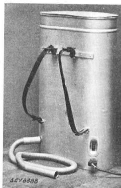
**Beschreibung:** Apparat gemäss Abbildung für die Herstellung von Fischeritbelägen an Wänden. Unten eingebautes Gebläse bläst Korkgries durch den flexiblen Metallschlauch. Gebläse durch Einphasen-Seriemotor angetrieben. Schalter und Apparatestecker eingebaut.
