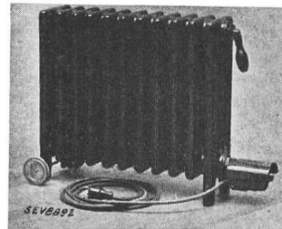
**Beschreibung:** Elektrischer Heizofen gemäss Abbildung. Radiator bestehend aus 11 Elementen, mit Wasser und Glycerin gefüllt. Heizstäbe unten eingebaut. Regulierschalter ermöglicht den Betrieb des Ofens mit der halben oder ganzen Heizleistung. Netzanschluss mit dreiadriger, mit Stecker versehener Gummiaderschnur.
