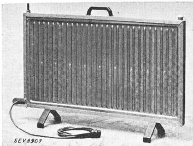
**Beschreibung:** Elektrischer Heizofen gemäss Abbildung. Flacher Wasserbehälter aus Aluminiumblech. Heizstab unten eingebaut. Oben am Rahmen Isolierhandgriff, Einfüllstutzen und Wasserstandsanzeiger. Netzanschluss mit dreiadriger, mit Stecker versehener Gummiaderschnur.
