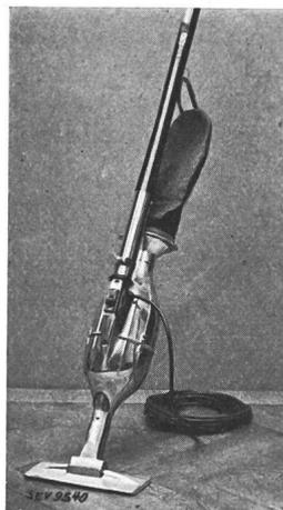
**Beschreibung:** Elektrischer Staubsauger gemäss Abbildung. Zentrifugalgebläse, angetrieben durch gekapselten Einphasen-Seriemotor. Motoreisen vom Gehäuse isoliert. Führungsstange aus Holz.
