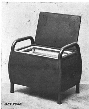
**Beschreibung:** Elektrischer Heiz- und Dörröfen gemäss Abbildung, in der Hauptsache aus Blech hergestellt. Heizwiderstand unten im Kasten angeordnet. Eingebauter Schalter ermöglicht Regulierung der Heizleistung in drei Stufen. Der Ofen ist mit einem Dörrreinsatz mit vier Gittern versehen. Zum Dörren soll der Ofen nur auf Stufe 1 (300 W) verwendet werden. Apparatestecker für den Anschluss der Zuleitung.
