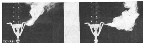
Fig. 4. Wanderung des Lichtbogenstiels vom Hornkniek an das Hornende ( I = 700 A).
