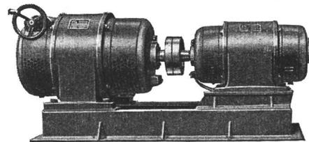
Umformerguppe, bestehend aus: Drehstrom-Nebenschluss-Kommutatormotor 500..2000 U./min, regulierbar, gekuppelt mit Einphasen-Synchron-Generator mit variabler Frequenz 50..200 Hz.
