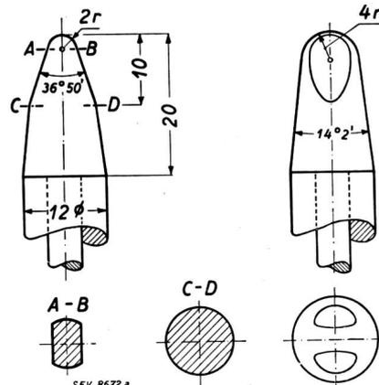
Fig. 1. Tastfinger für die Prüfung der Berührbarkeit spannungsführender Teile. Masse in mm.
