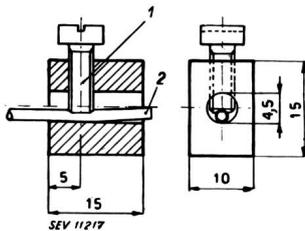
Fig. 1. Anschlussklemme mit geschlossenem Leiter
