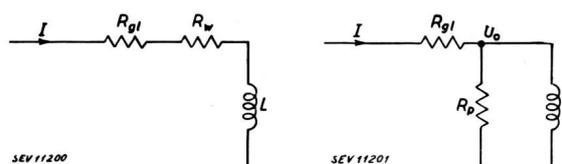
Fig. 1. Fig. 2. Ersatzschema der Massekernspule  $R_w, R_p$  Wirbelstromverluste.
