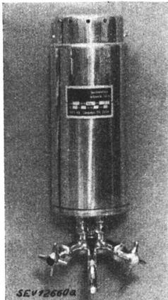
**Beschreibung:** Durchlauferhitzer mit Speichergefäß, gemäss Abbildung. Spiralförmiger Heizstab und Temperaturregler mit Sicherheitsvorrichtung von oben her eingeführt. Speichergefäß gegen Wärmeabgabe isoliert. Klemmen für den Anschluss der Zuleitung.
