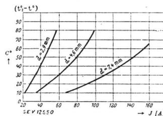
Fig. 4 Erwärmung in Abhängigkeit von der Stromstärke
