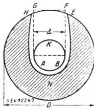
Fig. 1 Antennenseil mit Eisansatz
