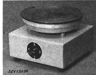
**Beschreibung:** Rechaud mit Eisenplatte von 200 mm Durchmesser, gemäss Abbildung. Sockel aus Eisenblech mit eingebautem Regulierschalter. Apparatestecker mit Schutzkragen angebaut.
