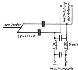
Fig. 3 Antennenheizung
