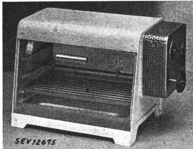
**Beschreibung:** Grill mit drehbarem Spieß, Gitterrost und Auffangblech gemäss Abbildung. Oben sind Heizelemente mit Glühspiralen angebracht. Grill vorn und hinten mit Glas abgeschlossen. Regulierschalter, Apparatestecker und Griff zum Drehen des Spießes seitlich angebracht.
