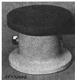
**Beschreibung:** Rechaud gemäss Abbildung. Gussplatte von 180 mm Durchmesser auf emailliertem Blechsockel. Widerstandsdraht in Masse eingebettet. Regulierschalter mit Stufen 0, 4, 3, 1 und Apparatestecker eingebaut.
