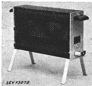
**Beschreibung:** Heizofen gemäss Abbildung. Widerstandsspiralen zwischen Eternitstäben gespannt. Gehäuse aus Guss und perforiertem Blech, Füsse aus Flacheisen. Apparatestecker für den Anschluss der Zuleitung.
