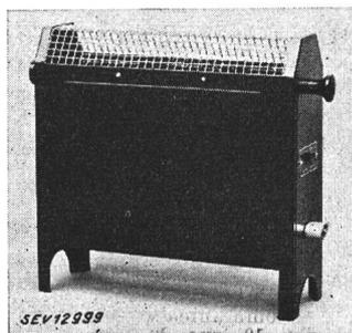
**Beschreibung:** Heizofen gemäss Abbildung. Widerstandsspiralen auf durch Blechrahmen verstärkter Eternitplatte befestigt und diese, durch keramisches Material isoliert, in Blechgehäuse eingebaut. Das Gehäuse ist unten und oben durch Drahtgitter abgeschlossen. Seitlich ist ein Kipphebel-Regulierschalter eingebaut. Apparatestecker für den Anschluss der Zu-
