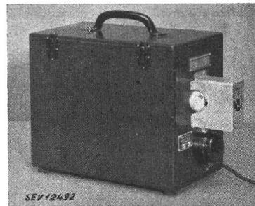
**Beschreibung:** Apparat gemäss Abbildung zum Trocknen von Materialproben in Laboratorien. In 170 x 300 x 250 mm grossem ventiliertem und mit Asbest und Glanzeternit ausgekleidetem Sperrholzkasten sind zwei Kohlefadenlampen und ein Temperaturregler eingebaut. Der Temperaturregler ist verstellbar. Zur Aufnahme des Trockengutes befindet sich oben im Kasten ein Drahtgitter. Netzanschluss mit zweidrader, mit Stecker versehener Rundschnur. Einpoliger Kipphebel-schalter angebaut.
