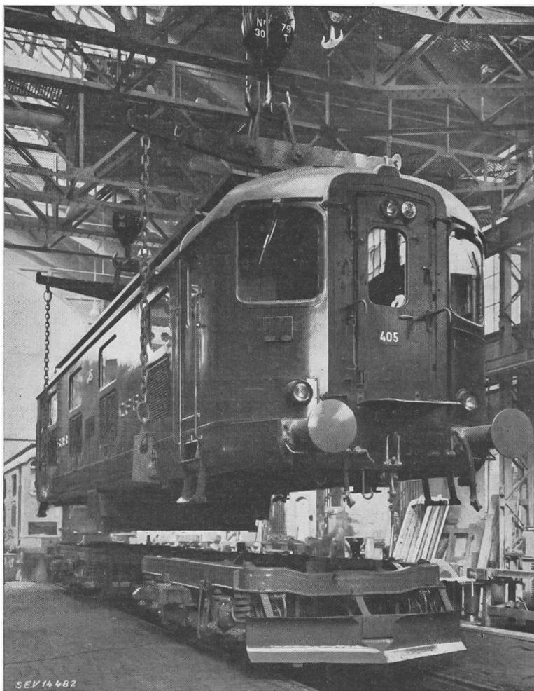
Zusammenbau der SBB-Leichtschnellzugs-Lokomotive Re 4/4
