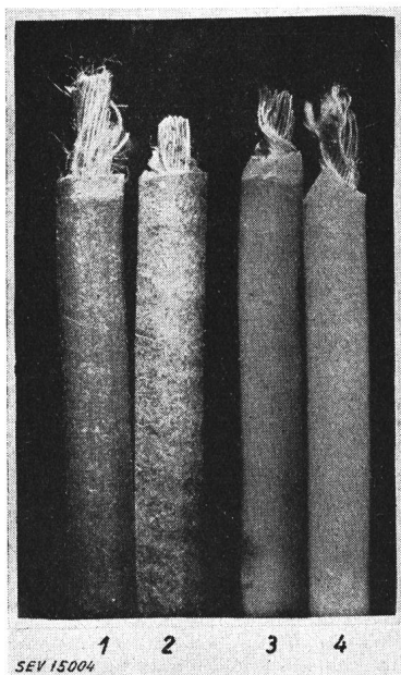
Fig. 4 Câbles isolés exposés 1 et 2 heures aux effets de l'ozone 1 et 2 Caoutchouc naturel 3 et 4 Thermoplaste à base de chlorure de polyvinyle
