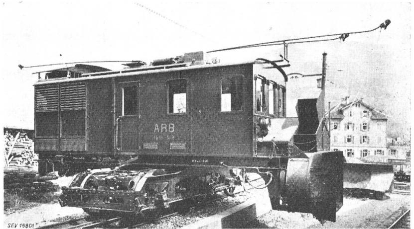
Die Gewichtsreduktion war so bedeutend, dass der Kasten mit dem ganzen Schleuderantrieb unter Zwischenschaltung einer Art Drehscheibe auf das Fahrgestell der Schneeschleudermaschine gesetzt werden konnte (Fig. 1). Die Maschine wurde, wie die elektrische Lokomotive, in beiden Fahrrichtungen betriebsfähig und vom Vorhandensein ortsfester Drehscheiben oder deren Freilegung unab-
