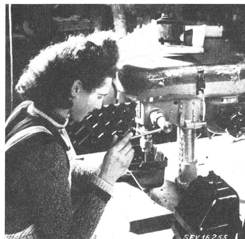
Fig. 3 Verputzen des fertig gepressten Gehäuses des Telephonapparates
