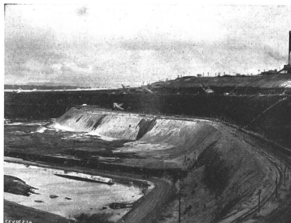
Fig. 1 Abbau der Braunkohlschicht Das Wasserbecken im Vordergrund dient zur Speicherung des Löschwassers im Brandfall
