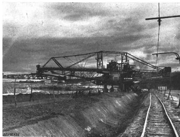
Fig. 2 Abbau-Bagger, der gleichzeitig die zum Transport benötigte Fahrbahn herstellt
