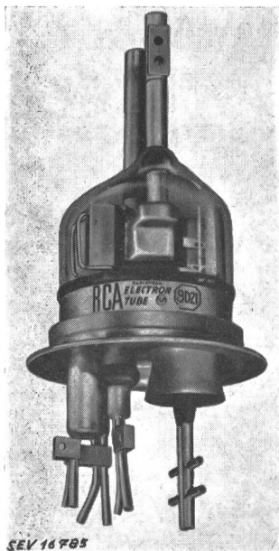
Fig. 5 6-kW-Sende- Doppeltetrode, RCA-8D21 Push-Pull- Leistungsverstärker für maximale Betriebsfrequenz von 300 MHz und maximale Anodenspannung von 6000 V
