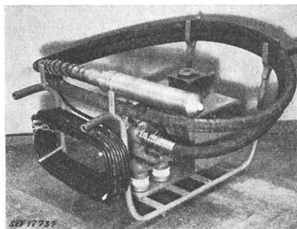
gestell mit isolierten Handgriffen montiert. Antriebsvorrichtung und damit auch die Tauchnadel von denjenigen Teilen isoliert, welche bei Isolationsdefekt unter Spannung kommen können. Schalter für Bedienung mit Zugschnur eingebaut. Vieradrige Zuleitung fest angeschlossen, Aufwickelvorrichtung vorhanden. Gewicht der ganzen Einrichtung ca. 80 kg.
