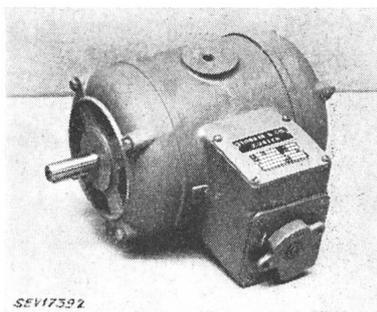
Erdungsklemme und Stopfbüchseineinführung für die Zuleitung im Klemmenkasten. Der Motor ist für den Antrieb von Betonvibratoren bestimmt. Er wird nach dem Zusammenbau durch eine Blechverschalung vor Spritzwasser und Regen geschützt.
