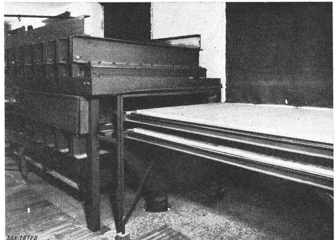
durch eine solche profilierte Türe. Eine Platte mit Abmessungen von  $180 \times 60 \times 2,5$  cm ist in 8...10 min verleimt und bereit, weiter bearbeitet zu werden (Schleifen, Beizen, Polieren). Die Elektrodenanordnung zeigt Fig. 10. Die Profile bedingen Einlagen aus Hartholz oder einem wärmebeständigen, nicht leitenden Material. Um das elektrische Feld und somit die Erwärmung homogen zu gestalten, darf die Elektrode nicht den Konturen der Platte folgen, sondern sie muss plan bleiben.
