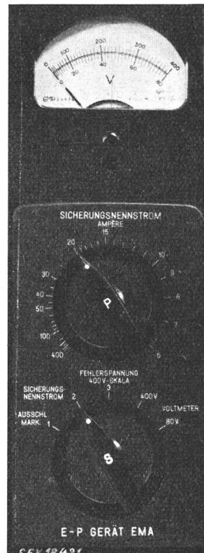
Fig. 10 Skala für Sicherungsnennstrom (Griff P ) und Bezeichnungen der Schalterstellungen (Griff S )
