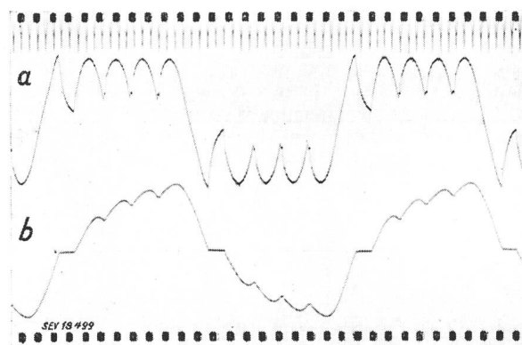
Fig. 12 Oszillogramm des Ausgangsstromes eines Frequenzwandlers (Frequenz f = 13 Hz) a Spannung; b Strom
