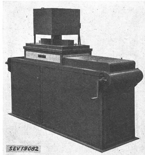
Fig. 11 4-kVA-Strahlungssofen zum Einbrennen von Transparentlack auf vergoldeten Uhrenbestandteilen
