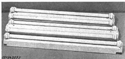
oben offenem Sockel aus Aluminiumblech, Armaturen für zwei und drei Lampen auf geschlossenem Sockel aus Aluminiumblech montiert. Lampen durch spritzwassersichere Fassungen festgehalten. Vergossene Vorschaltgeräte eingebaut. Verbindungsdosen aus keramischem Material mit Stopfbüchsen. Verbindungsleiter mit Thermoplastisolation. Erdungsklemmen vorhanden.
