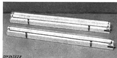
schlössern gegen Gummidichtung gepresst. Vergossene Vorschaltgeräte mit eingebautem «Knobel»-Thermostarter, Lampenfassungen und Anschlussklemmen auf Blecheinsatz montiert. Stopfbüchsen aus Metall für Leitereinführung. Erdungsklemmen vorhanden.
