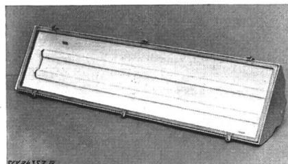
mit Flügelmuttern festgehalten. Vergossene Vorschaltgeräte, Lampenfassungen und Anschlussklemmen auf Blecheinsatz montiert. Stopfbüchse aus Isolierpreßstoff für Leitereinführung. Erdungsklemmen vorhanden. Die gleiche Armatur wird auch für 2 Fluoreszenzlampen ausgerüstet.
