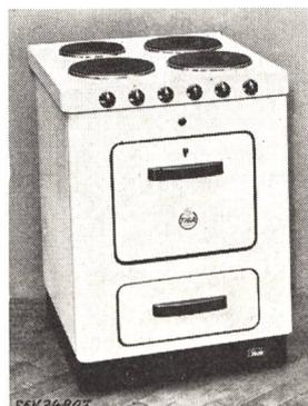
Kochherd gemäss Abbildung, mit 4 Kochstellen, Backofen und Schublade. Feste Herdschale aus emailliertem Blech. Platten von 180 und 220 mm (drei Stück) Durchmesser mit Rand aus rostfreiem Stahlblech, fest montiert. Backofenheizkörper ausserhalb des Backraumes angeordnet. Anschlussklemmen für verschiedene Schaltungen eingerichtet. Handgriffe aus Isoliermaterial.
