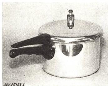
Der Boden hat bei der Formbeständigkeitsprüfung nur eine geringe Deformation erlitten. Solche Kochtöpfe sind somit für die Verwendung auf elektrischen Kochplatten geeignet.
