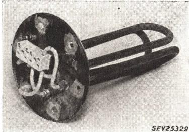
Enden sind mit Keramikperlen isoliert und auf die Klemmen geführt. Erdungsklemme am Flansch.
