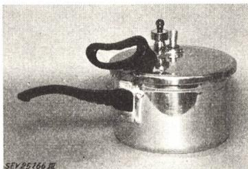
Der Boden hat bei der Formbeständigkeitsprüfung nur eine geringe Deformation erlitten. Solche Kochtöpfe sind somit für Verwendung auf elektrischen Kochplatten geeignet.
