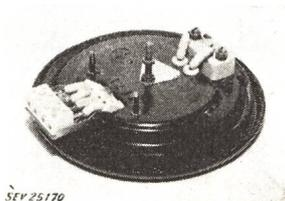
schalter unterbricht bei Überhitzung der Kochplatte einen Teilwiderstand. Erdleiteranschluss am Schraubenbolzen unten an der Kochplatte. Gewicht 2,1 kg.
