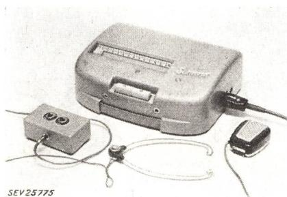
drei Kleinsicherungen. Einphasen-Kurzschlussankermotor für den Antrieb der Walze. Tonkopf für Aufnahme und Wiedergabe. Handmikrofon mit Schalter zur Steuerung des Apparates. Separater Gabelkopfhörer. Netzanschluss durch Doppelschlauchschnur mit Apparatesteckdose und Stecker 2 P + E. Gehäuse aus Metall. Separates Blechkästchen mit Eingangsübertrager, zwei Schaltern und zwei Zuleitungen mit Stecker für den Telephonanschluss.
