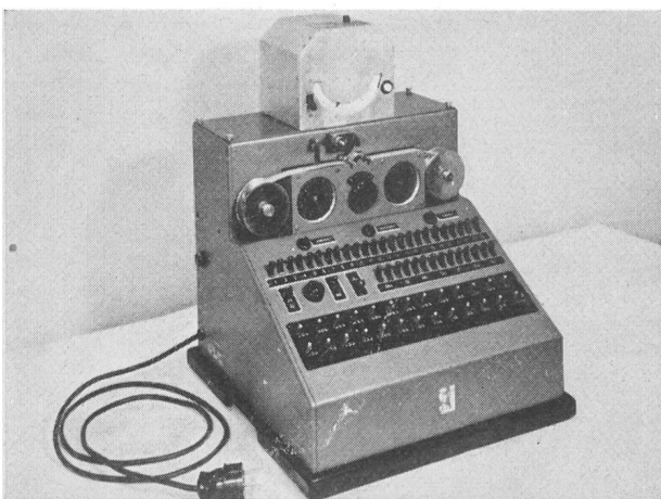
Fig. 6 Auswertautomat, System Ferrarì Der Aufbau der Deckplatte ist eine Spezialentwicklung der BEWAG
