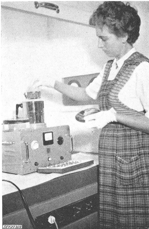
Fig. 9 Ultraschallbad zur Reinigung von Kathodenteilen
