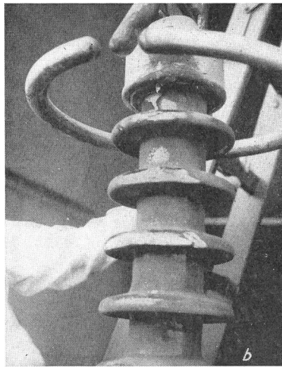
Fig. 5 Zerstörungen an Isolatoren nach einem Lichtbogenüberschlag
