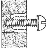
Einfachste Montage **von vorne**, ohne Gegenmutter. Durch Eindrehen der Spreizmade erfolgt Verkeilung der Hülse, was eine zuverlässige Befestigung gewährleistet.
