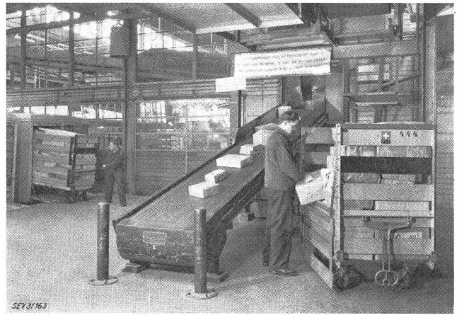
Fig. 5 Beladestellen eines Paketförderbandes
