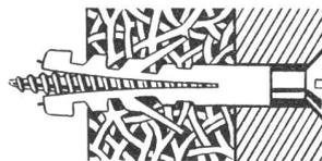
seulement 8 grandeurs de tampons pour vis de  $\varnothing$  2,5 à 15 mm et longueurs quelconques
