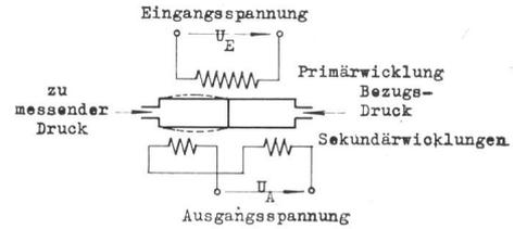
Differentialtransformatoren mit einem verschiebbaren, zylindrischen Kern aus ferromagnetischem Material messen geradlinige Bewegungen. Die magnetische Kopplung zwischen der primären und den beiden se-
