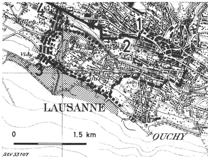
Fig. 3 Principales poses de câbles prévues pour alimenter l'Exposition Nationale 1964 — Réseau 50 kV existant — Câble 50 kV ••••• Câble 6 kV ▨ Aire de l'Exposition 1 Vers Pierre-de-Plan; 2 Station 50/6 kV Sébeillon; 3 Station 50/6 kV Expo; 4 Vers Banlieue-Ouest
