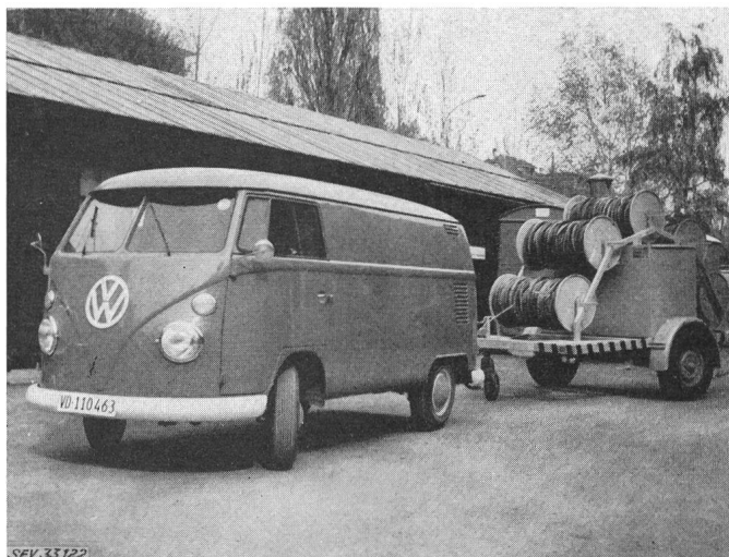
Fig. 18 Véhicule de l'équipe d'exploitation des réseaux de l'Exposition équipé d'un radio-téléphone et d'une remorque avec torche de câble volant pour liaisons de secours
