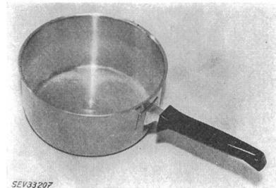
Der Boden hat bei der Formbeständigkeitsprüfung nur eine geringe Deformation erlitten. Solche Kasserollen sind daher für Verwendung auf elektrischen Herden geeignet.
