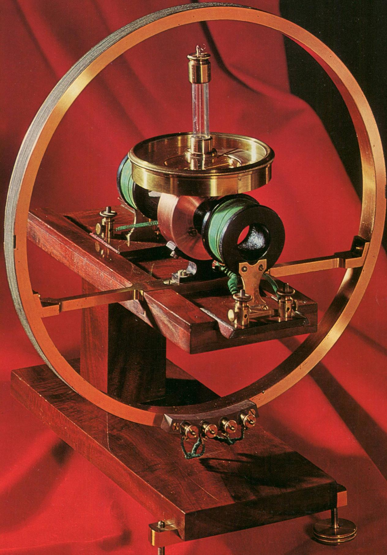
**Titelblatt:** Tangentenbussole aus dem Jahr 1837. Das elektrische Messinstrument diente zur Messung von Gleichströmen. Es ist mit zwei Spulen versehen, die auf eine Magnetnadel wirken. (Aus der Sammlung von *W. Acklin*, Zürich.)
